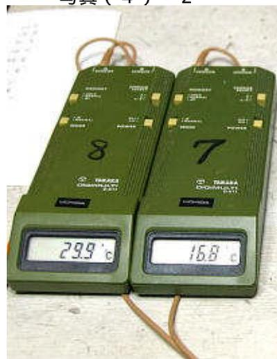
長時間通電すると、安定状態になり、温度の変化は殆ど無くなる。その状態に達した時点で、負荷電流を変えながら端子電圧を測定し最大電力を測定した。それぞれのペルチェ素子に流す電流で温度差は変化するが、17 程度の温度差を得るのがやっとであった。
