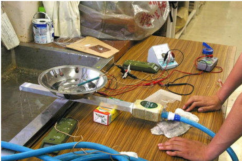
水道水を流した 2 cm × 2 cm のアルミパイプ 2 本を低温側とした。高温側は熱湯を入れた金属製(ステンレス)のボールを使い、高温側の温度を調整し温度差を作り熱起電力を測定した。
